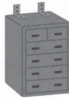
▲家具の固定は、L字金具で固定する方法が一般的です。
