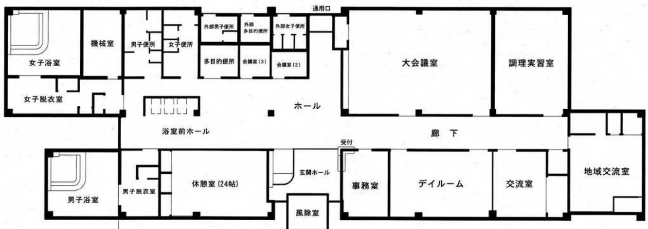
構造:鉄骨造 階数:平屋建 延べ床面積:約800m<sup>2</sup>
